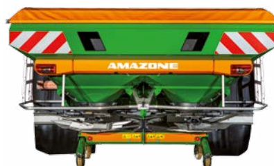
Nadstawka L 2700 (szerokość napełniania 2,71 m) ze składanymi drabinkami
