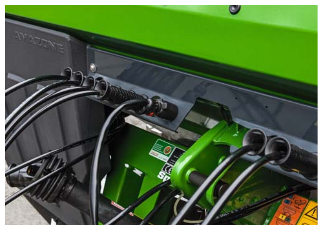
Przejrzysty uchwyt węży hydraulicznych
