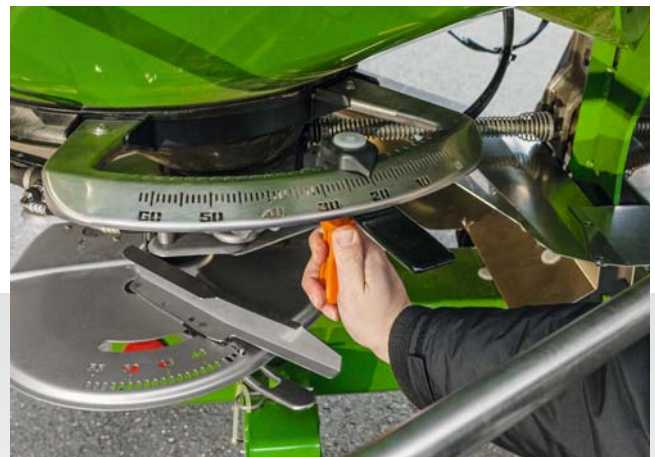
Proste przestawienie konsoli zasuw
