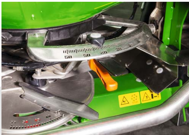
Dźwignia regulacyjna z dużą skalą
